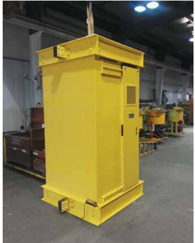
Mit dem Bestehen des Tests auf Lotrechtigkeit ist der neue Wartungskorb bereit zur Verladung
