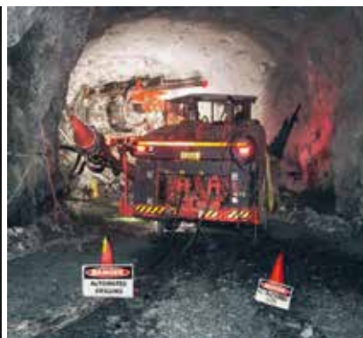
Teilautomatisierter Bohrwagen untertage
