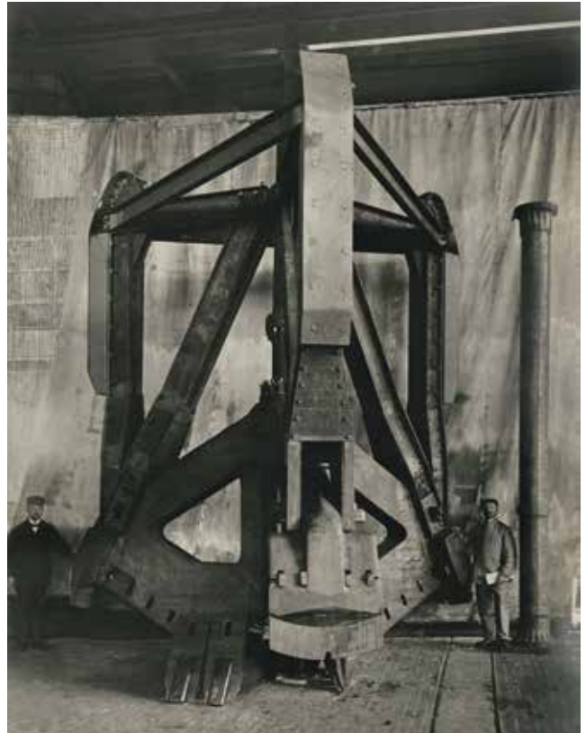
Gewerkschaft Deutscher Kaiser, Abteilung Schachtbau: Anlage Friedrichsfeld, Bohrmeißeldes Kind-Chaudron-Verfahrens, ca. 1912
