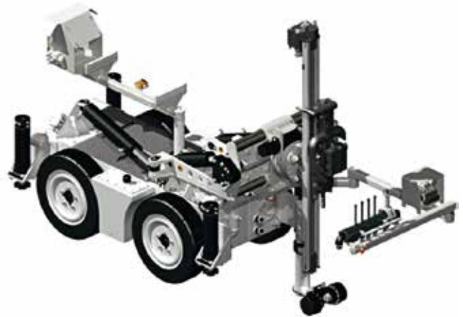
PLH – der erste druckluftbetriebene Langlochbohrwagen wurde 1995 entworfen und ist heute weltweit anerkannt
