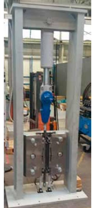
Gesamtkonstruktion der von OLKO neu entwickelten Hub- und Klemmvorrichtung (HuK)
